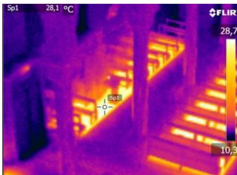
**Nella foto termografica a sinistra è possibile vedere l'effetto di un impianto SYRMA HYDRO dopo alcuni giorni di funzionamento, la temperatura dell'aria interna alla chiesa si attesta intorno ai 12-13°C più che sufficienti per un comfort termico adeguato.**
